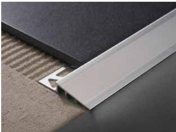
RAMPTEC ZRR est un profil en aluminium anodisé étudié pour raccorder sols de niveau différent. L'angle d'inclinaison d'environ 20° crée un raccord doux entre le dénivélé et permet un passage en toute sécurité entre les deux sols. Le côté vertical du profil dispose de la section caractéristique de nos profilés en "queue d'aronde" pour un meilleur ancrage mécanique avec la colle et le mastic, sur le point de plus forte contrainte. Ancrage vertical avec section en "queue d'aronde".
